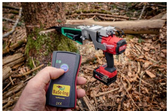
Ferngesteuerte Fällhilfen können aus sicherer Distanz bedient werden und reduzieren daher das Unfallrisiko stark. (Photo: BaSt-Ing)
